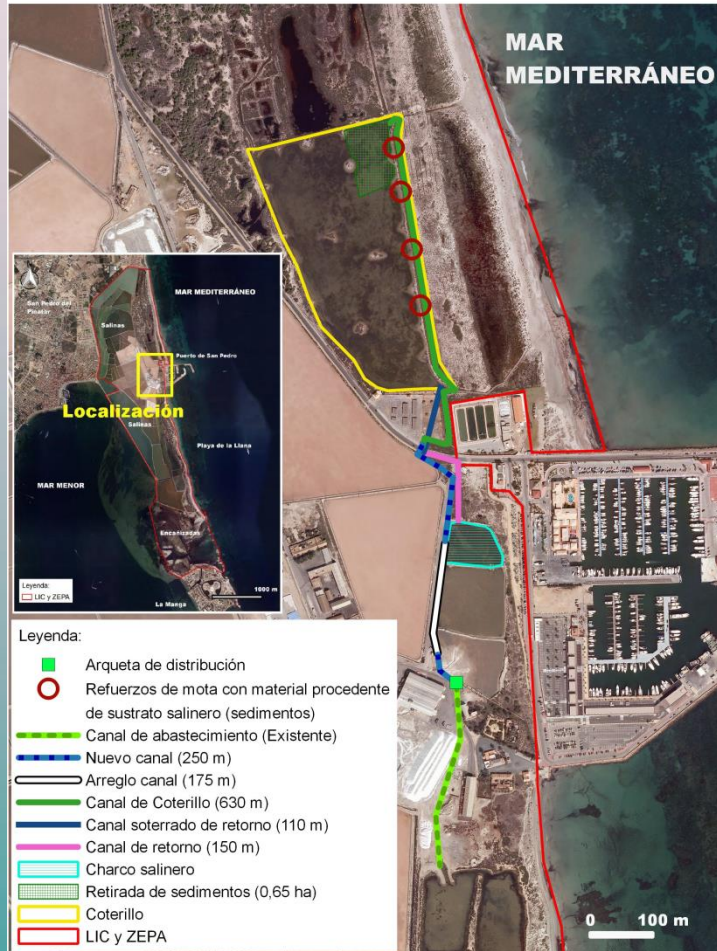
Título: Acción C2. Infraestructura verde de conexión de la Charca de Coterillo con el circuito Salinero.
